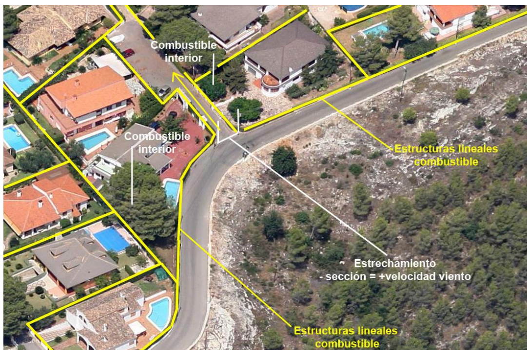
Imagen 53. Las calles o viales (estrechamientos) del propio núcleo pueden constituir corredores de fuego en los que además puede producirse una aceleración (similar a un efecto chimenea a pequeña escala) por el estrechamiento de la sección que supone aumento de velocidad ( S \times V = S' \times V' ). Fuente: Medi XXI GSA.
