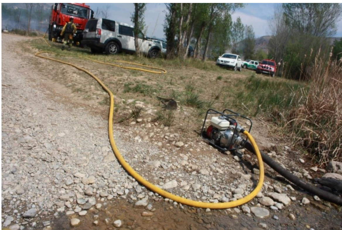
Imagen 9. Abastecimiento de vehículo autobomba desde fuentes no convencionales. Toma mediante mangote y motobomba desde un curso de agua. Chulilla, Valencia. Fuente: Dalmau-Rovira, F. 2014 Medi XXI GSA
