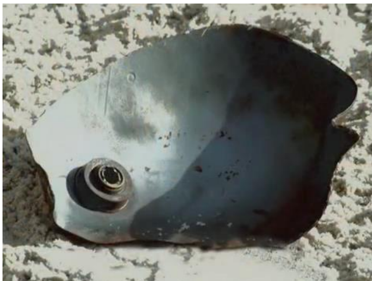
Imagen 87. Fragmento de metralla procedente de una bombona de gas tras explosión por incendio forestal que afectó a un área de acampada. (Fuente: Medi XXI GSA)
