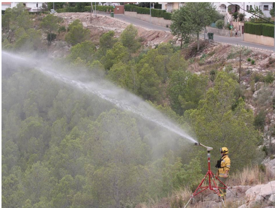
Imagen 92. Preparación de zona de impacto mediante utilización de monitores portátiles SIDEINFO. (Fuente: Medi XXI GSA)
