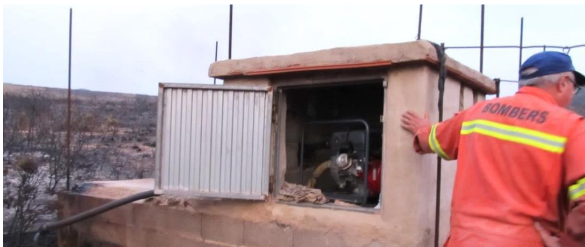
Imagen 10. Abastecimiento de tendido de manguera a partir de motobomba asociada a un aljibe. Incendio Forestal de Cortes de Pallás. Fuente: Dalmau-Rovira, F. 2012 Medi XXI GSA.
