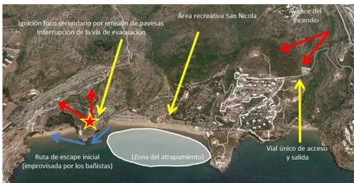
Imagen 43. Esquema descriptivo de la situación de atrapamiento por incendio forestal en San Nicola, Puglia, Italia. Julio de 2007. Un fuego amenaza un camping cuya única vía de evacuación queda comprometida. Los campistas se meten en el mar y tratan de autoevacuarse a una cala próxima cuando se produce un foco secundario en su ruta de escape. Fuente: elaboración propia a partir de informes del suceso.
