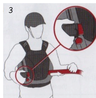
3 Tirar del cinturón de suelta rápida hasta que quede totalmente estirado.
