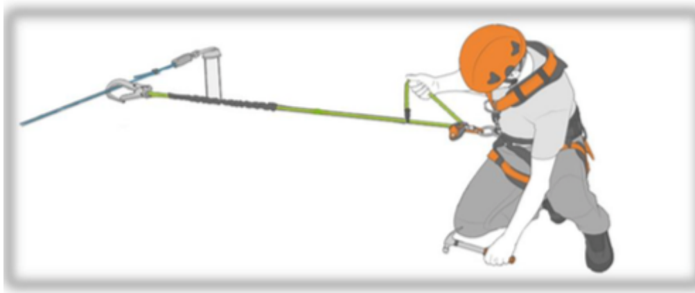
Ejemplo de sistema de retención mediante un elemento de amarre ajustable UNE-EN 358 y UNE-EN 795 B
